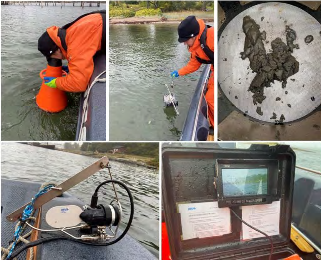
Figur 25. Metodikk som ble benyttet ved befaringen av de tre grunne bløtbunnsområdene: vannkikkert, liten van Veen grabb, sikt med sikkerest, undervannskamera med skjerm og mulighet for videooptak.
