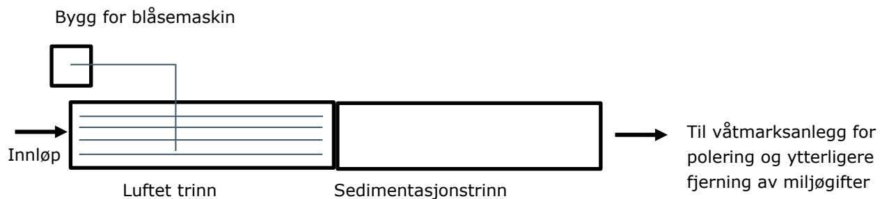
Figur 4. Prinsippkisse for et renseanlegg for jernfjerning
